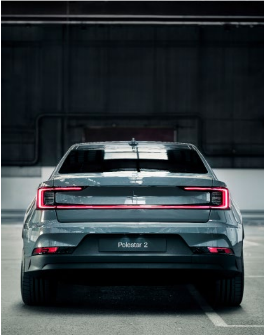
Det bakre lysbladet bruker 288 LED-dioder for å skape den unike lyssignaturen til Polestar 2.
